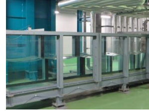
2次元造波水槽
