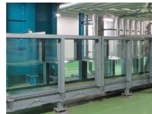
2次元造波水槽
