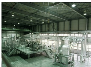
海洋温度差発電実験装置
