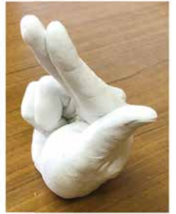
自硬成形技術を用いた試作品。指紋まで詳細に再現されている。
