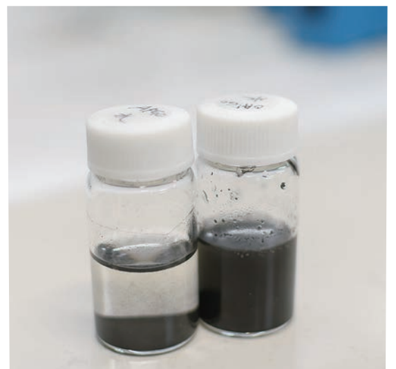
液体につけてグラフェンを分離している
