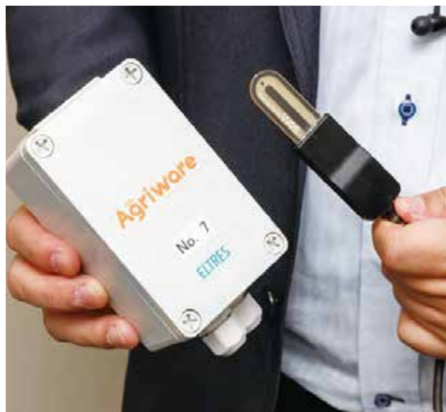
左はセンサーネットワーク端末5号機、右が土壌中に埋め込むセンサー
