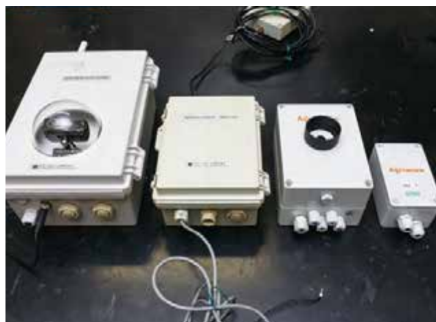
歴代のセンサーネットワーク端末。左から2号機(30×20cm)、3号機(21×16cm)、4号機(17.5×12.5cm)、5号機(12.5×7.5cm、最新の機種)
