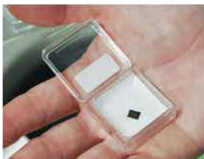
実験用に自作した太陽電池は5mm角ほど
