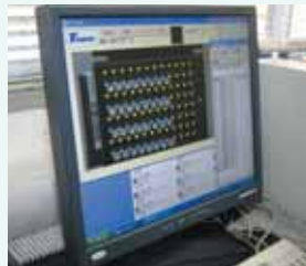
保存する血液サンプルは2次元バーコード入りのマイクロチューブでコンピュータ管理
